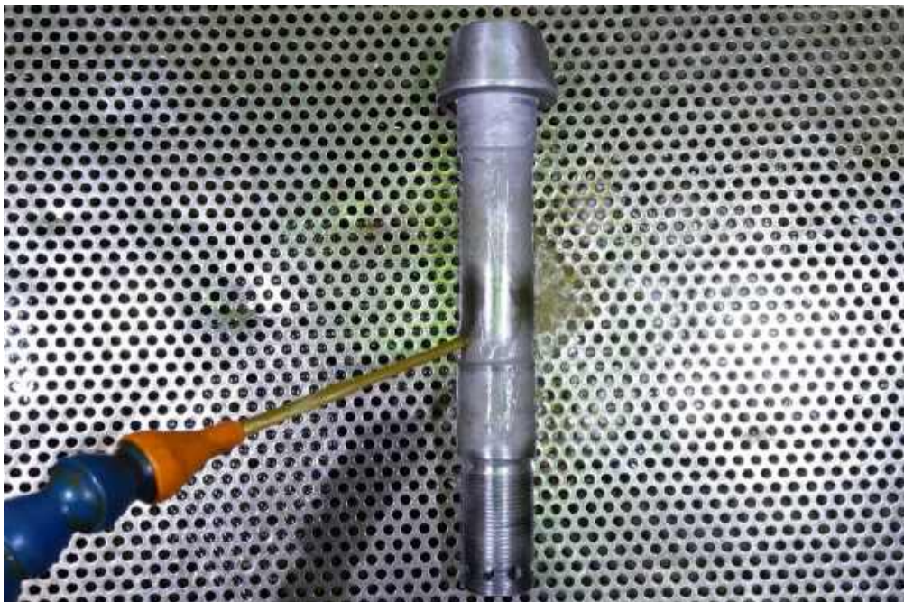
Рисунок 3.8 – Процес нанесення суспензії
