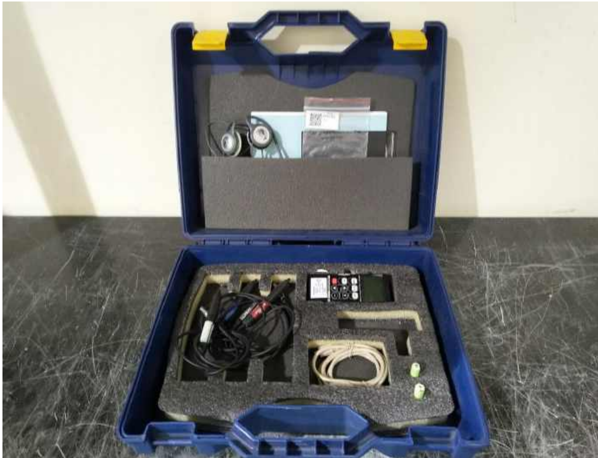
Рисунок 5.3 – Дефектоскоп «Константа ВД-1» з набором датчиків для різних матеріалів
