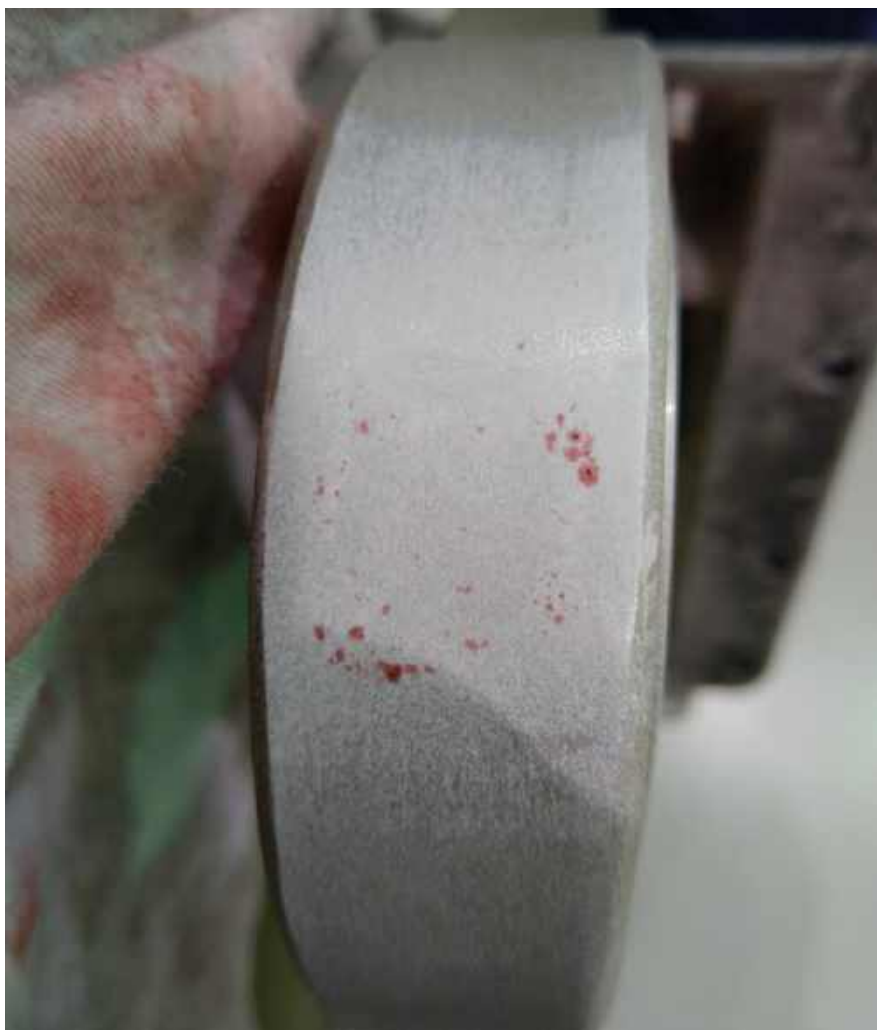
Рисунок 4.11 – Пори в матеріалі гасника вібрацій Мі-8
