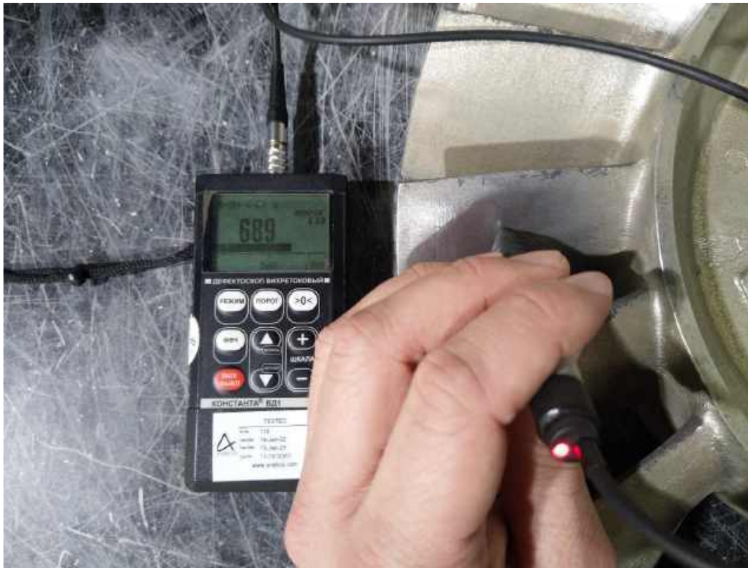
Рисунок 5.10 – Дефект глибиною 689 мкм, виявлений при вихороструминному контролі
