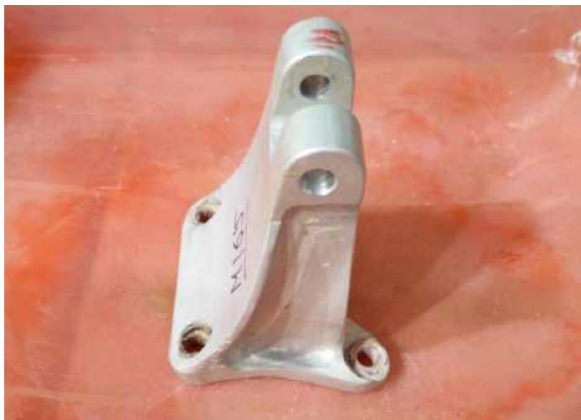
Рисунок 4.4 – Очищений та висушений кронштейн кріплення паливного бака в оглядовій зоні
