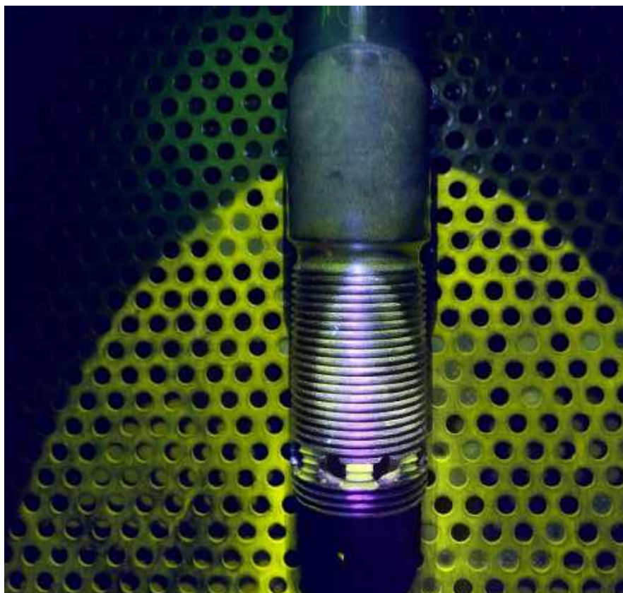
Рисунок 3.10 – Кріпильний болт, покритий магнітними частинками (жовтий) під ультрафіолетом
