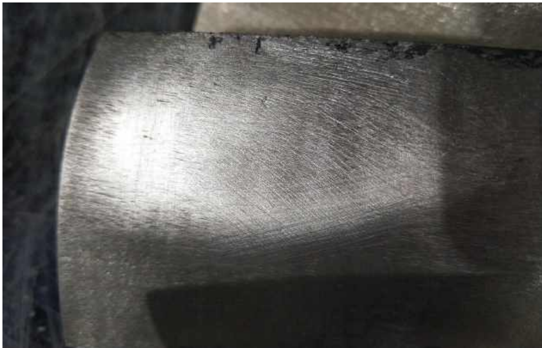
Рисунок 5.11 – Місце на лопаті, де виявлено дефекти
