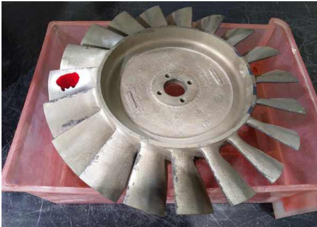
Рисунок 5.12 – Один із етапів капілярного контролю нагнітального колеса
