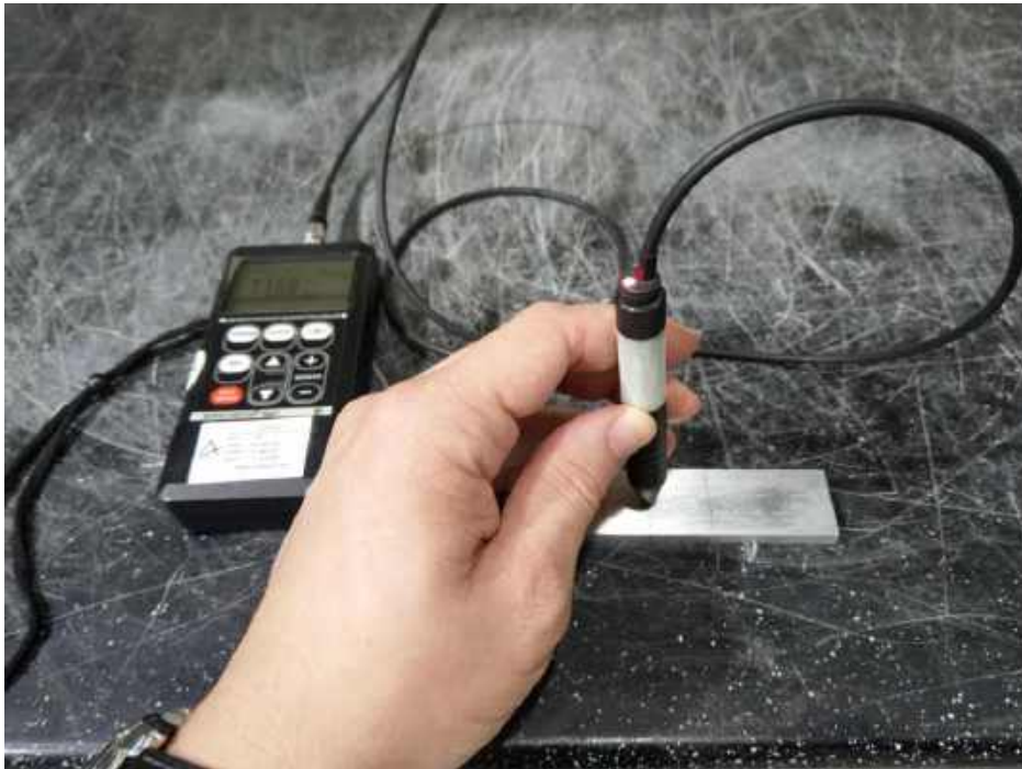
Рисунок 5.7 – Перевірка працездатності дефектоскопа
