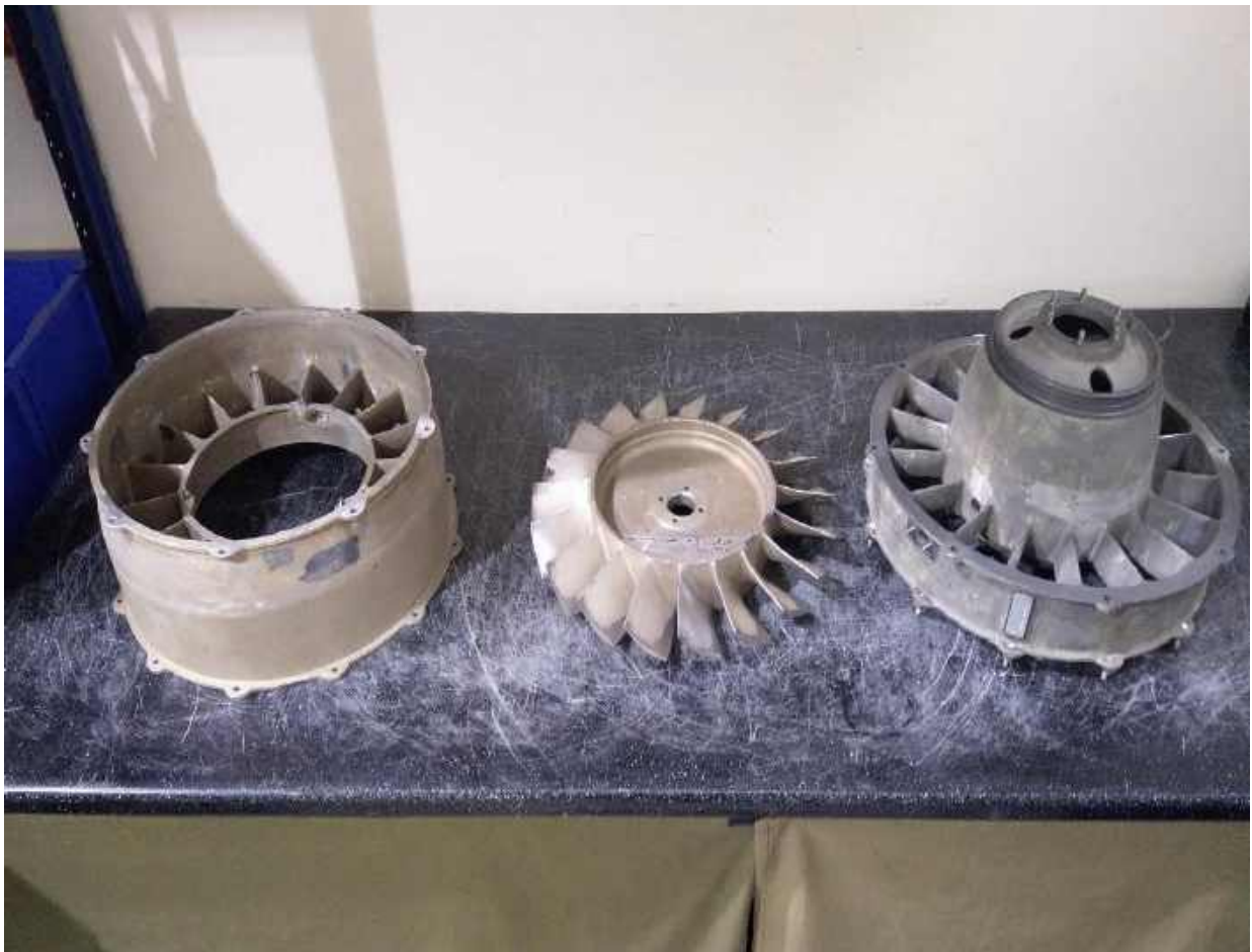
Рисунок 5.2 – Деталі вентилятора, що випробовуються вихорострумним методом
