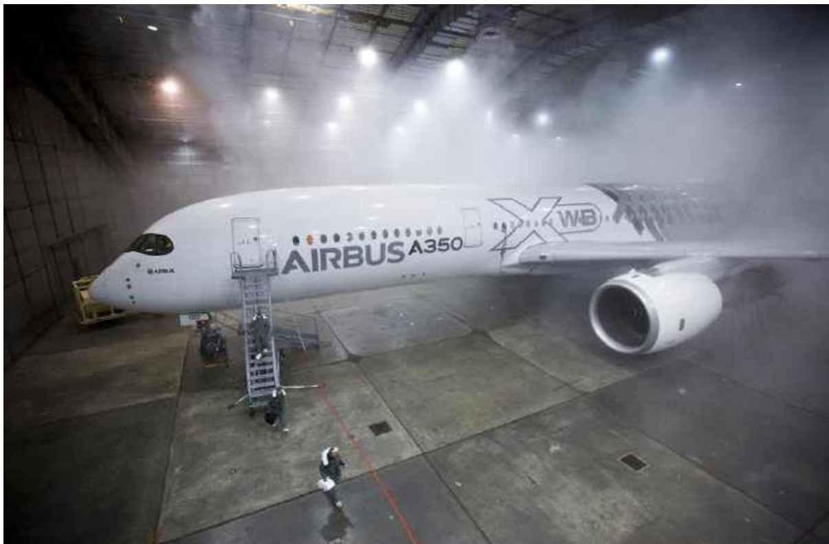
Рисунок 6 – Двотижневі випробування Airbus A350 XWB у Кліматичній лабораторії Мак-Кінлі у Флориді, США
