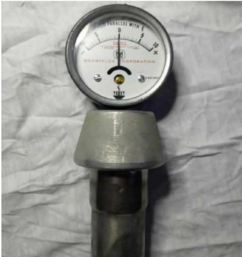
Рисунок 3.15 – Положення стрілки приладу біля розмагніченої деталі
