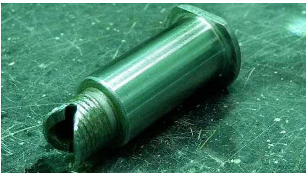
Рисунок 3.16 – Циліндрична полірована поверхня болта, яка має практично ідеальний вигляд при видимому світлі
