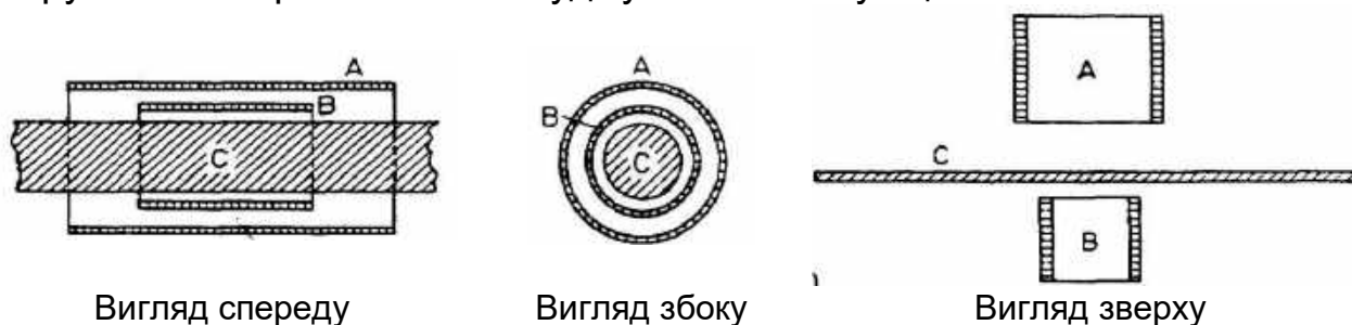
Рисунок 5.1 – Розташування обмоток та зразка, що випробовується, при вихороструминному контролі
