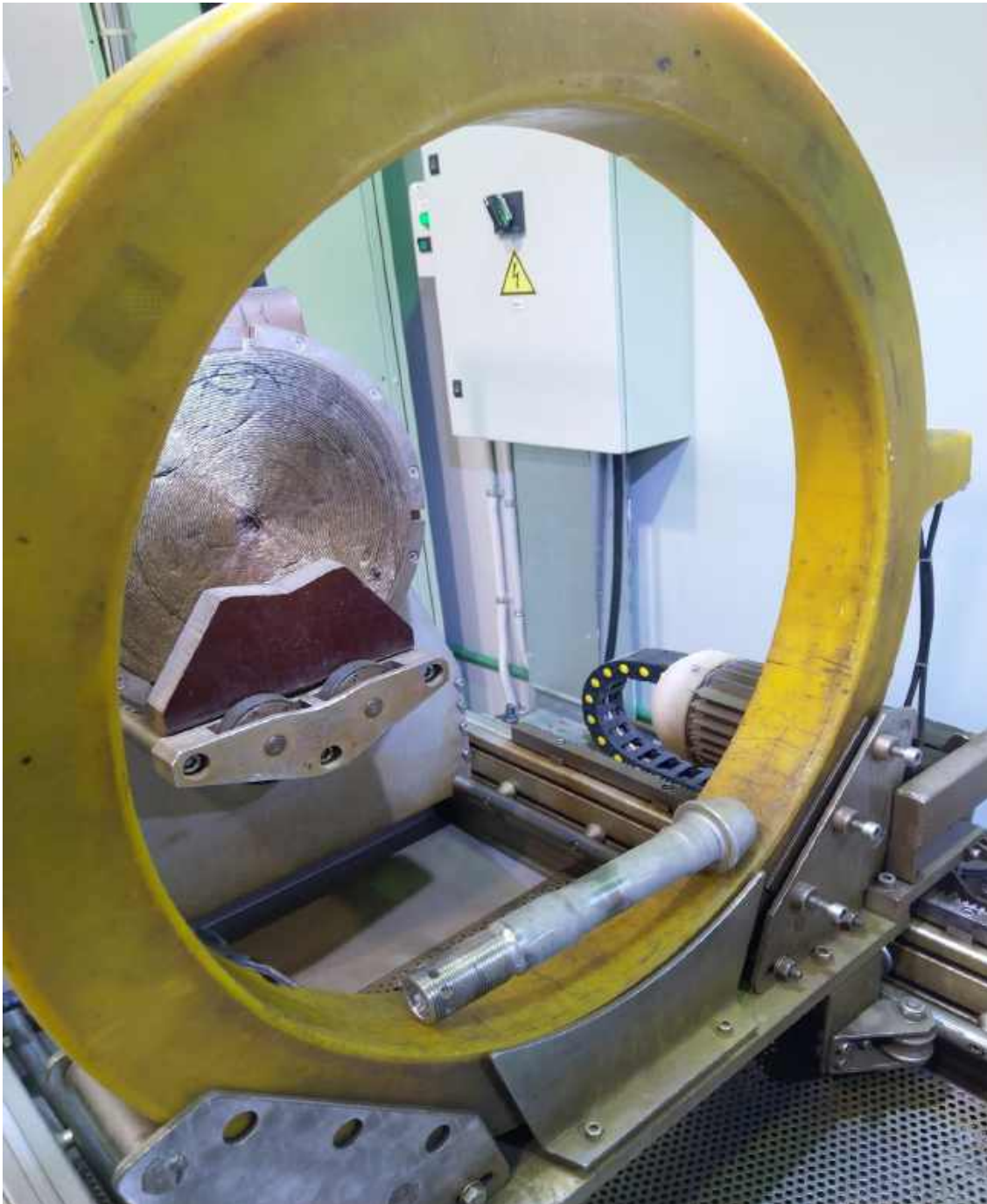
Рисунок 3.6 – Розташування болта в соленоїді машини
