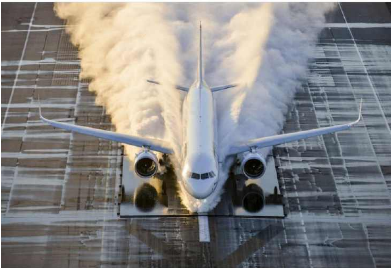
Рисунок 4 – Airbus A321neo під час випробування на влучення води в межах своєї сертифікаційної кампанії
