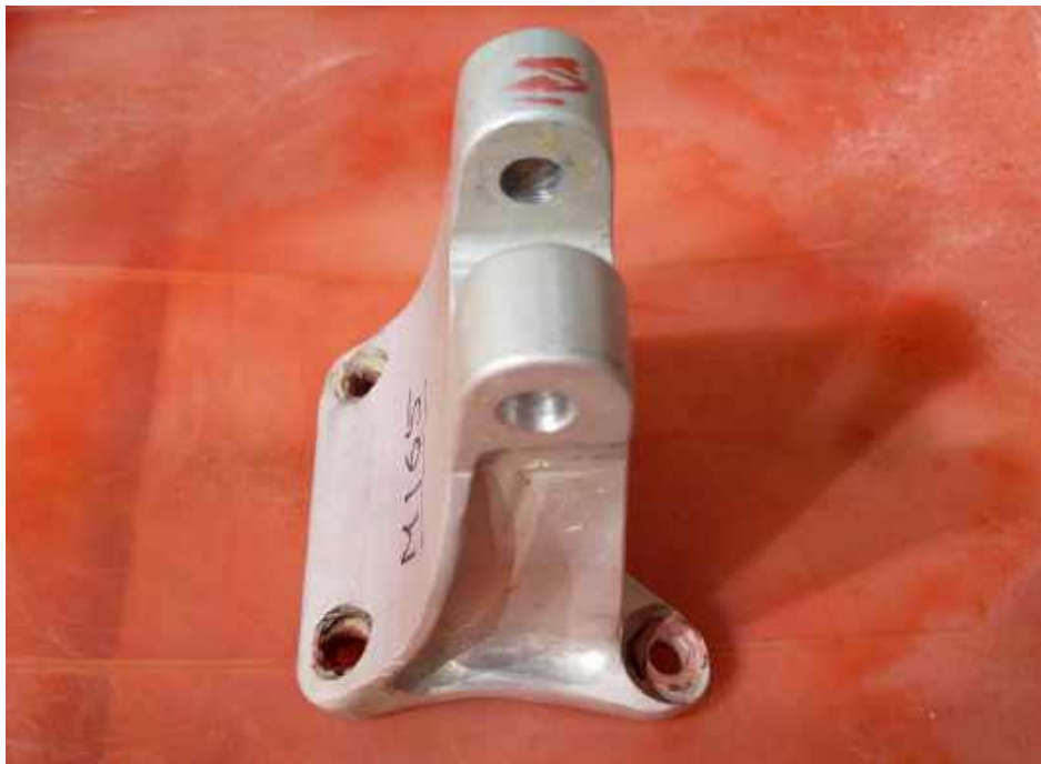
Рисунок 4.6 – Кронштейн паливного бака після видалення пенетранту та висихання
