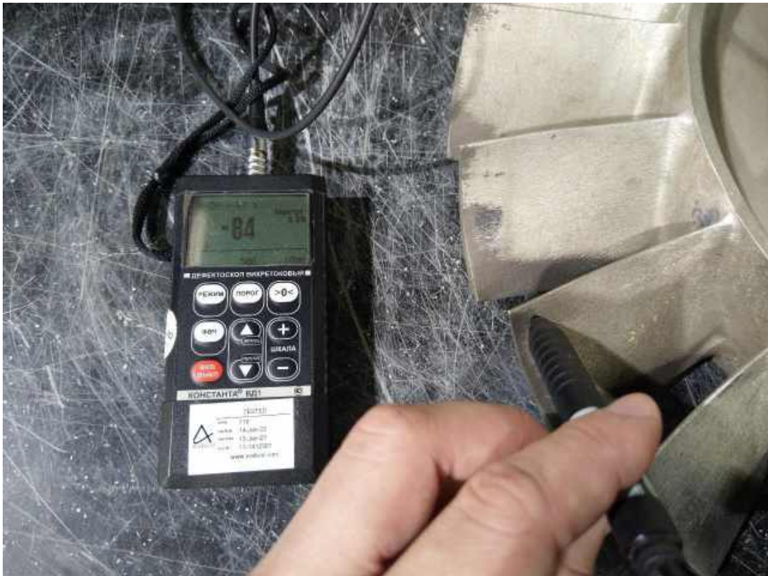
Рисунок 5.8 – Початок вихорострумінного тестування вентиляторного колеса
