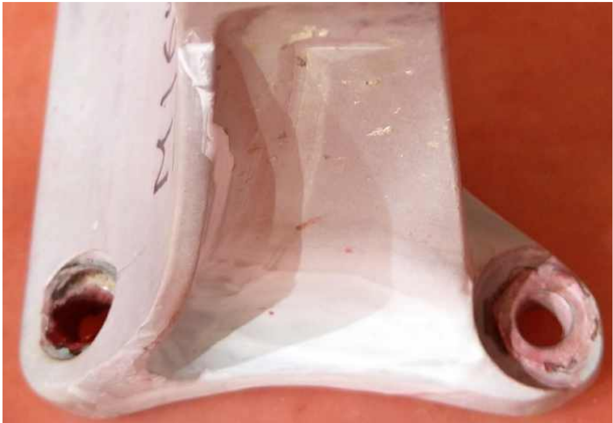
Рисунок 4.7 – Область кронштейна кріплення паливного бака, покрита білим проявником
