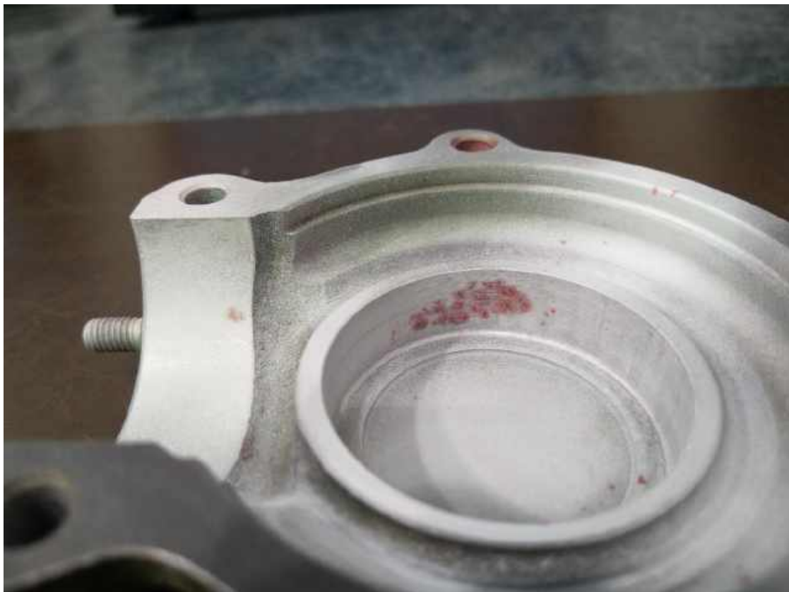
Рисунок 4.10 – Корозія на повітряному компресорі Мі-8
