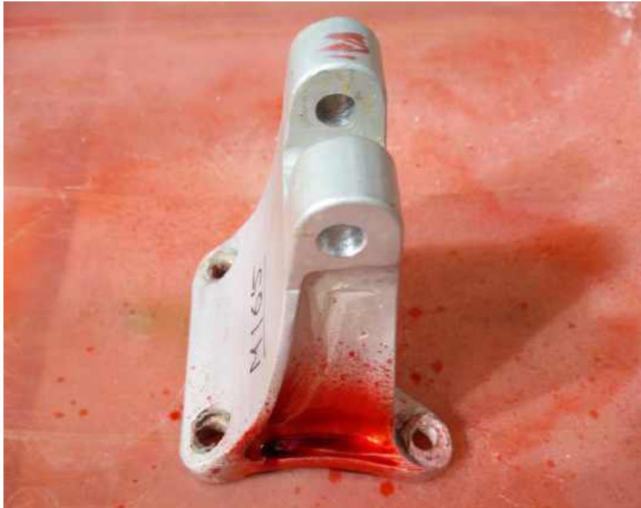
Рисунок 4.5 – Кронштейн паливного бака, покритий пенетрантом
