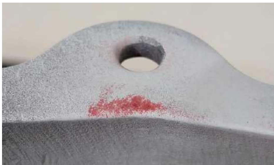
Рисунок 4.12 – Втомні тріщини в нагнітачі Мі-8
