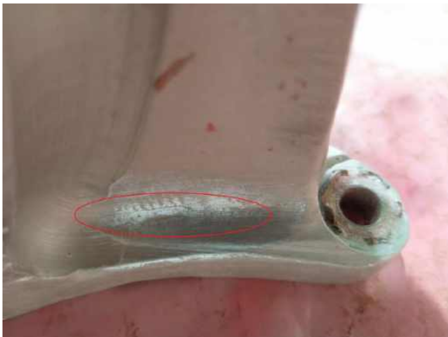
Рисунок 4.3 – Область з імовірним дефектом
