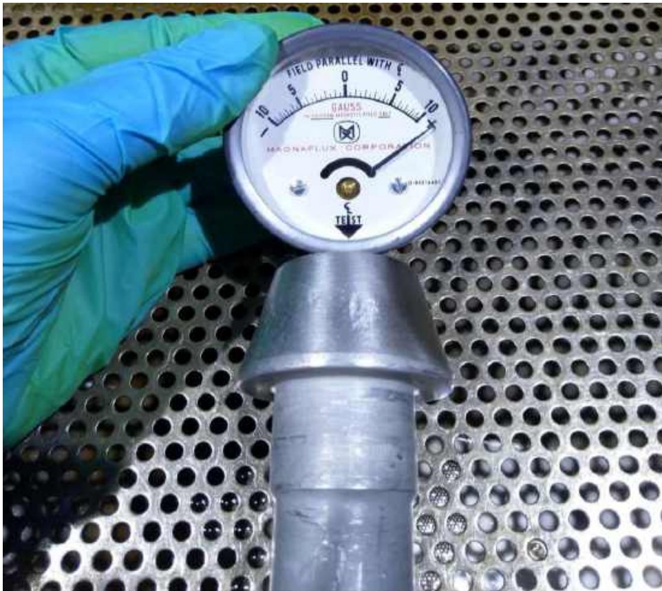
Рисунок 3.7 – Ступінь намагнічування деталі
