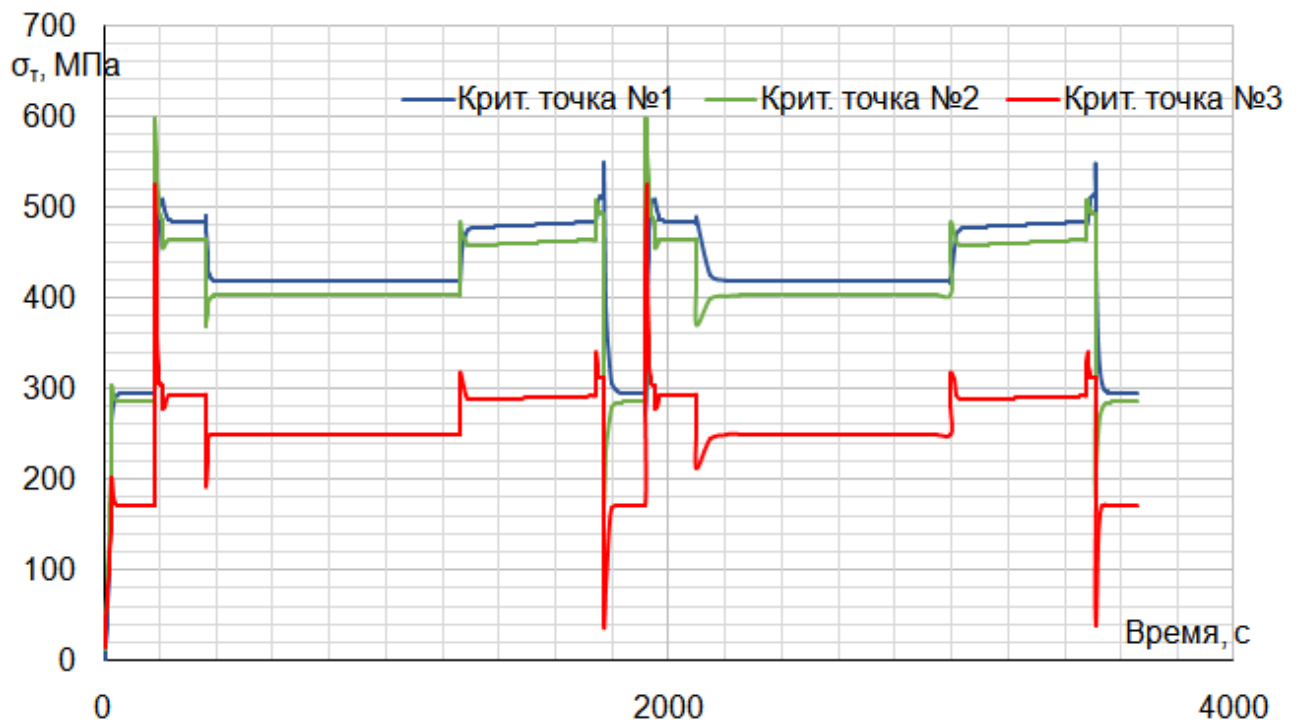
Рисунок 2.46 - Графік зміни радіальних напружень в критичних точках 1 (у маточині диска), 2 (в районі отворів під болти), 3 (в районі ободу).
