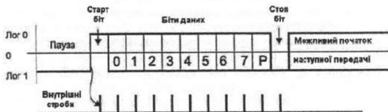
Рис. 4.9. Формат асинхронної передачі RS-232C
