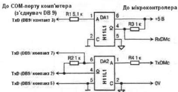
Рис. 4.7. Перетворювач рівнів RS-232C/ТТЛ з гальванічною розв'язкою
