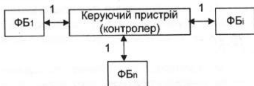
Рис. 1.2. Радіальна структура: 1 – дані, команди, статусна інформація, адреси; ФБ 1 , ФБ i , ФБ n – функціональні блоки
