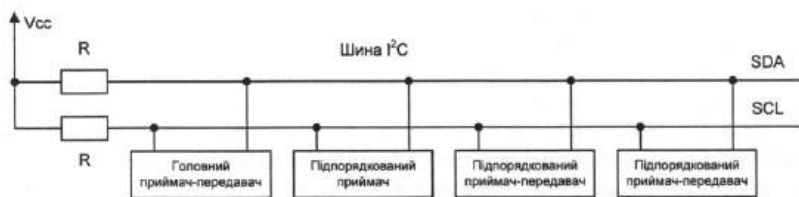
Рис. 2.1. Функціональна схема шини I 2 C
