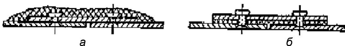
Рис. 7.1. Герметизація заклепувальних з'єднань: а – за допомогою паст та замазок; б – прокладками
