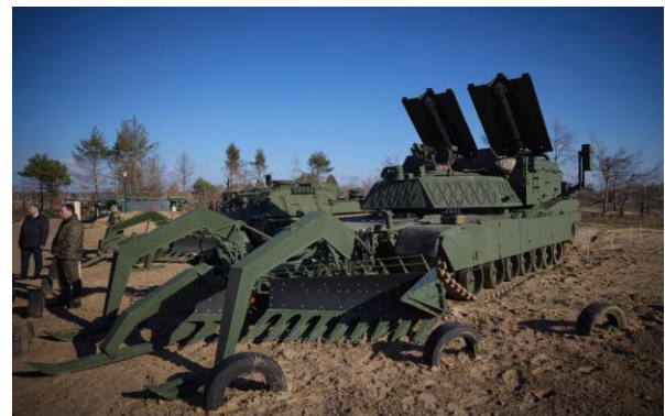
Рис. 8. Інженерна машина розмінування M1 Assault Breacher Vehicle (M1 ABV) з відкритими відсіками M58 MICLIC (нагорі) [5]
