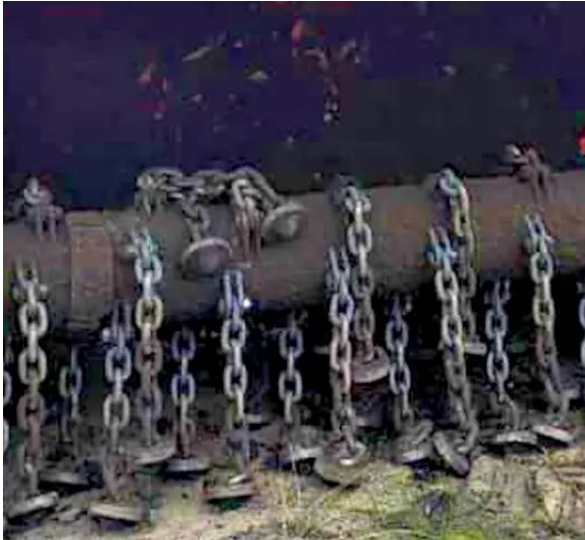
Рис. 5. Конструкція ланцюгового ротора [9]
