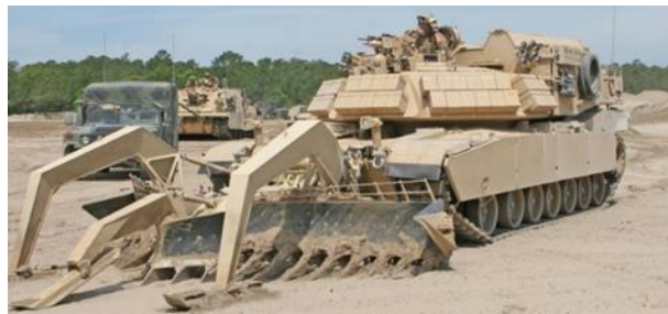
Рис. 1. Інженерна машина розмінування M1 Assault Breacher Vehicle (M1 ABV) [5]
