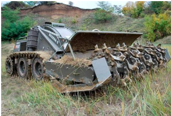
Рис. 6. Дистанційна система розмінування Вожепа 5 з роторною фрезною [8]
