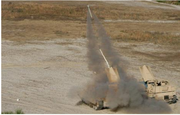
Рис. 9. Запуск лінійного заряду розмінування M58 MICLIC зі штурмової машини розмінування M1 Assault Breacher Vehicle (M1 ABV) [5]
