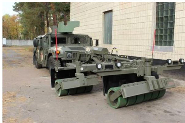
Рис. 3. Трал SPARK у парі з Utility Vehicle M998 Humvee [7]
