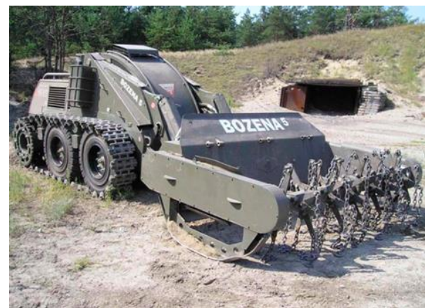
Рис. 4. Дистанційна система розмінування Vožena 5 з ротором ланцюгового типу [8]
