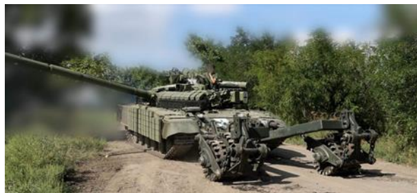
Рис. 2. Танк Т-64БВ зразка 2017 року з колійним мінним тралом [6]
