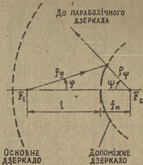
Рис. 1.5. Геометрія основного та допоміжного дзеркал
