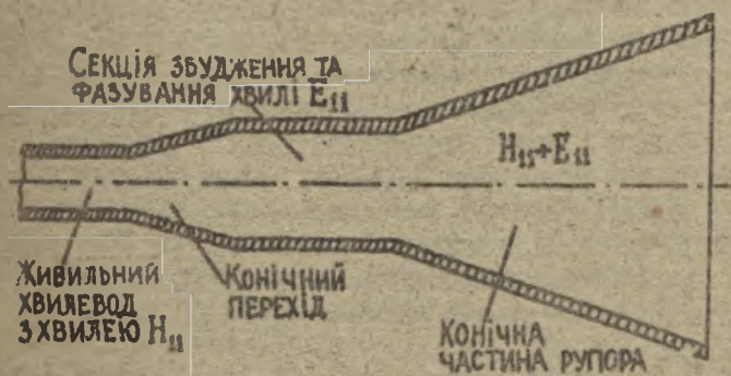
Рис. I.15. Спрямінювач у вигляді конічного рупора з використанням різномодових хвиль
