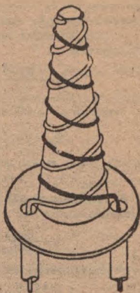
Рис. 3.16. Діодозахідна спіральна антена з протилежним напрямком намотки витків
