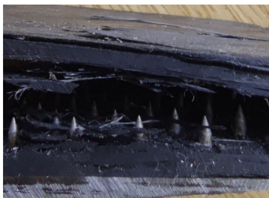
Рис. 12. Міжшарове розшарування та ступінчаста закінцівка. Зразок препаровано вздовж лінії дії навантаження
