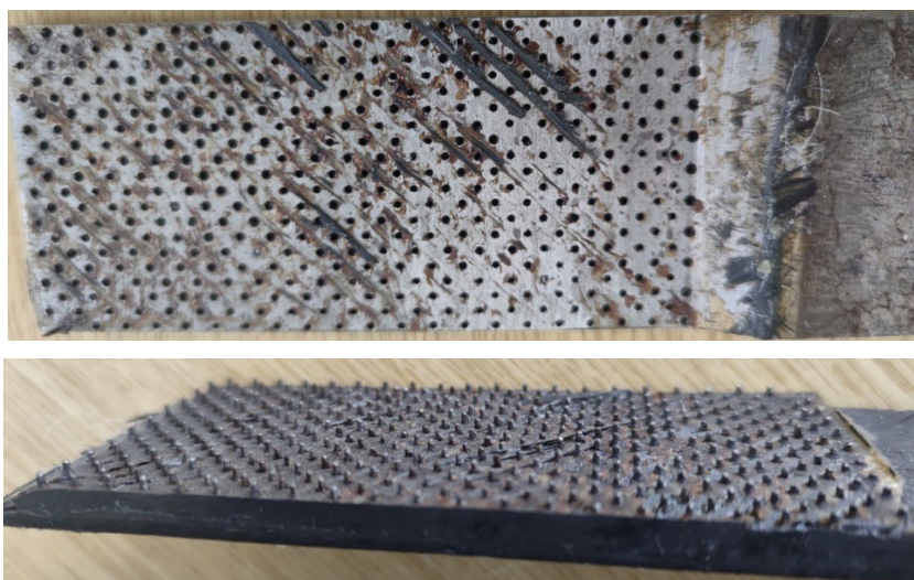
Рис. 10. Зовнішній вигляд повного відшарування пакету КМ (знизу) від металеві закінцівки (зверху). Усі циліндричні мікроелементи витягнуті з металеві закінцівки
