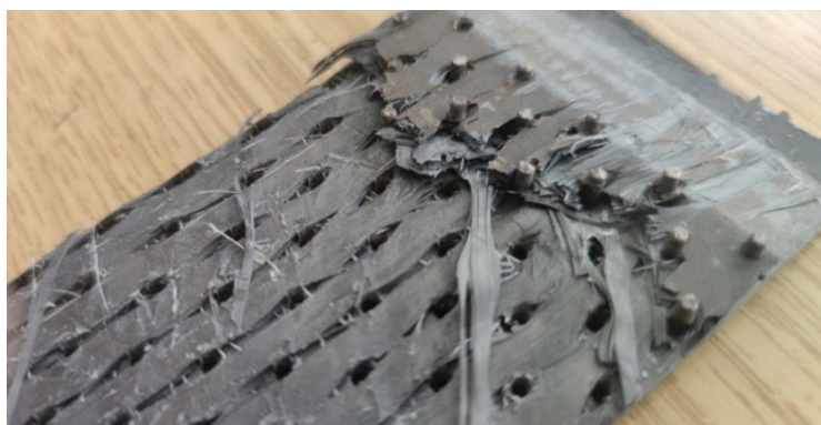
Рис. 14. Вид зверху на відшаровану частину пакету КМ
