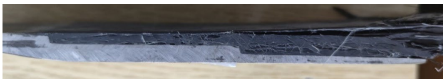
Рис. 11. Приклад міжшарового руйнування пакету КМ при ступінчастій металевій закінцівці. Місце зміни товщини показано колом. Знизу вигляд з бокового торцю, зверху вигляд під кутом на розшароване з'єднання
