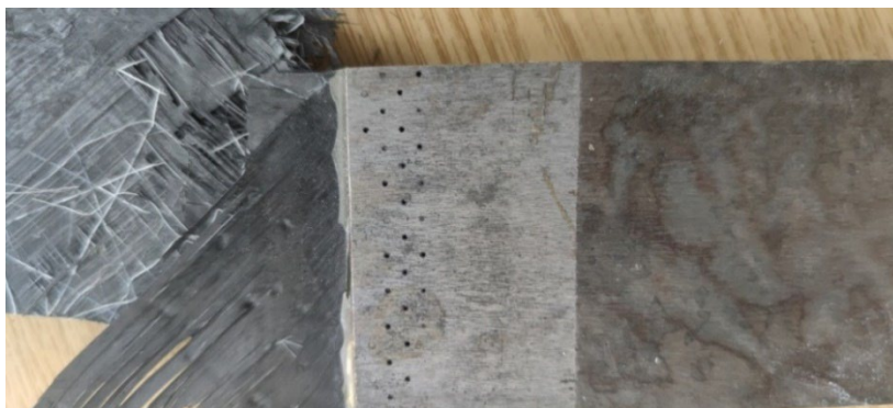
Рис. 13. Вид руйнування пакету КМ у регулярній частині, що торкається металевої закінцівки. Спостерігаються витягнуті із закінцівки МЕ у частині, що найближча до пакету КМ (чорні отвори)
