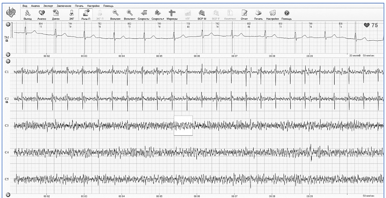
Рисунок 6.25 – Вікно програми результату поділу абдомінального сигналу на незалежні компоненти з використанням алгоритму SOBI
