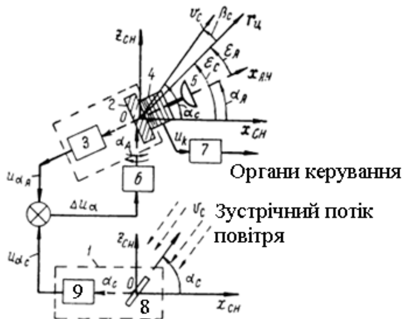
Рисунок 1.4 - Функціональна схема, системи самонаведення з силовим флюгером:
