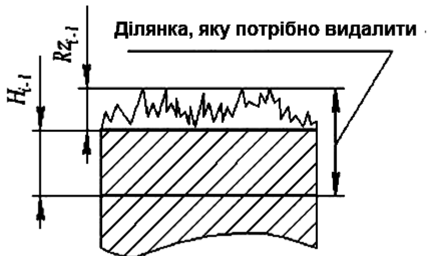
Рис. 1.15. Схема розміщення Rz_{i-1} та h_{i-1} на поверхні заготовки
