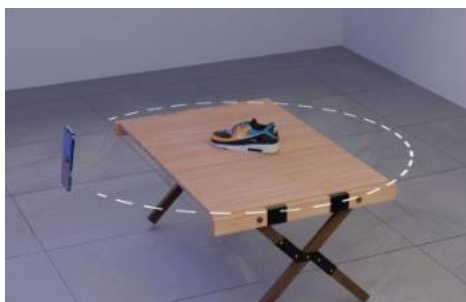
Рис. 1 – Сканування об'єкта за допомогою технології фотограмметрії
