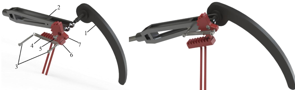
Рис. 2 – 3D-модель безпривідного захоплювального пристрою для транспортуванні тари під сипучу продукцію до дозатора: 1 – гак; 2 – корпус;
