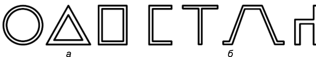
Рис. 7.2. Типи поперечного перерізу тонкостінних стержнів
