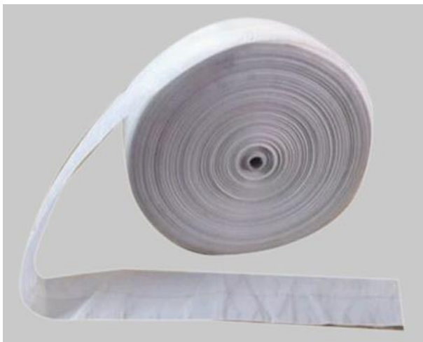
Рис. 2.3. Армувальні матеріали на основі найлону: а – найлонова стрічка; б – найлонова нитка
