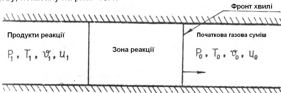
Рис. 10.1. Структура детонаційної хвилі
