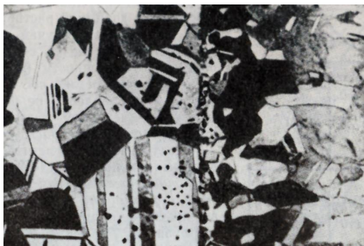
Рис. 2.7. Утворення пор у дослідженні Кіркендалла (зліва – \alpha -латунь, справа – мідь)( \times 55 )
