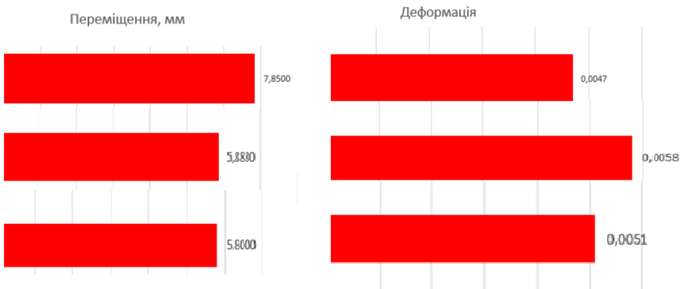
Рис. 3. Переміщення та деформація пластин, дубльованих склом
