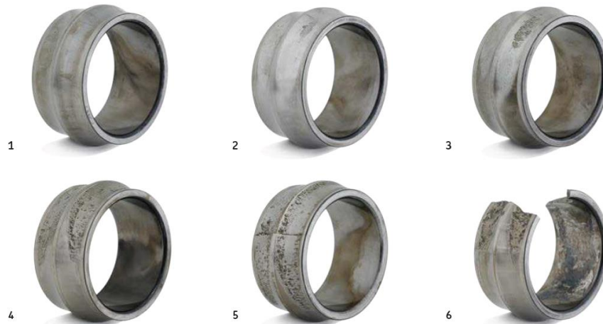
Рис. 2. Процес розвитку пошкоджень внутрішнього кільця підшипника
