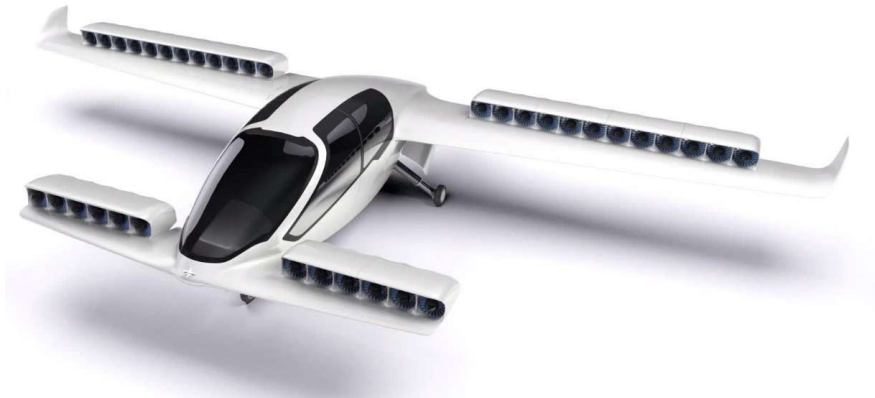
Рисунок 1.8 –Електричний конвертоплан, спроектований компанією «Lithium»
