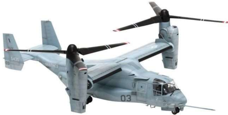
Рисунок 1.1 – Конвертоплан В-22 “Osprey” з поворотними гвинтами
