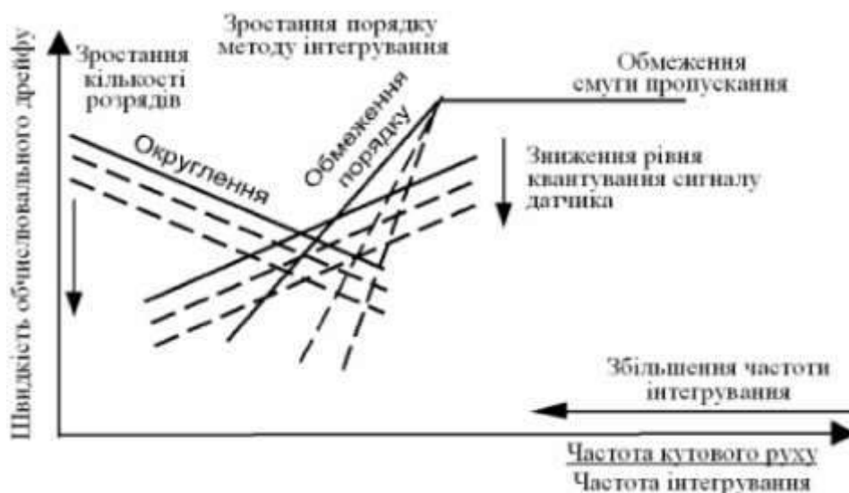
Рисунок 3.3 – Графік залежності похибки обчислень від вибраних параметрів
