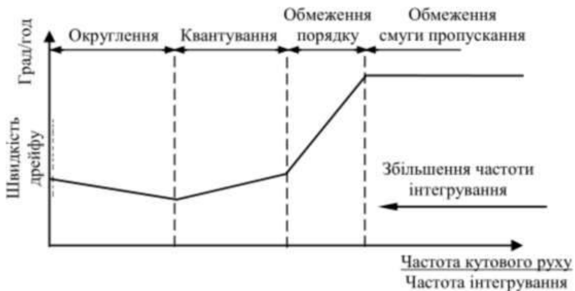
Рисунок 3.2 – Графік залежності зміни похибки обчислень від відношення частоти кутового руху до частоти інтегрування обчислювача
