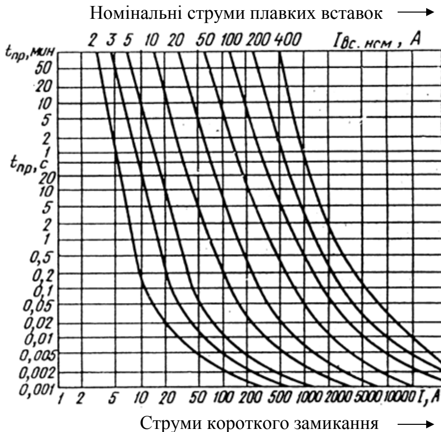
Рис. 6.6. Захисні характеристики запобіжника серії ПКТ-10
