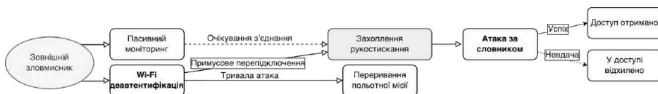
Рисунок 4.4 — Блок-схема комбінованого вторгнення в бездротову мережу
