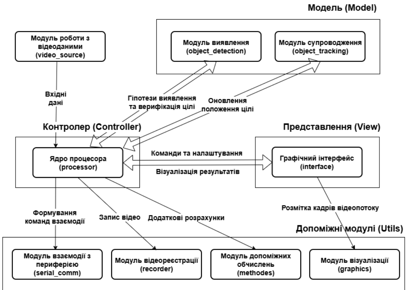
Рисунок 4.2 – Структурна схема взаємодії програмних компонентів системи
