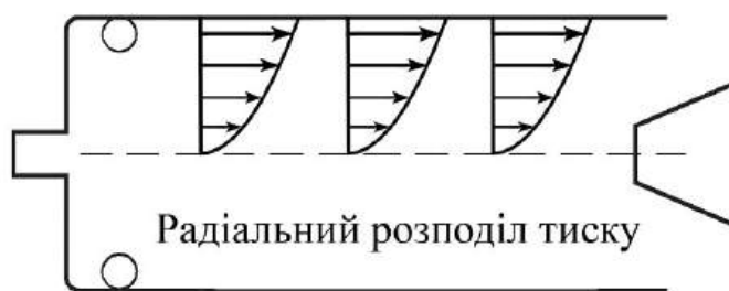
Рис. 1.4. Схематичне зображення радіального розподілу статичного тиску у вихровій трубі
