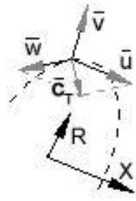
Рис. 3.10. Схема до пояснення вектора швидкості, дотичного до поверхні струму
