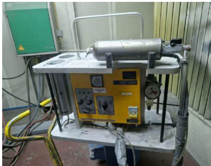
Рисунок 5.5 – Установка ХГН ДИМЕТ-403.
