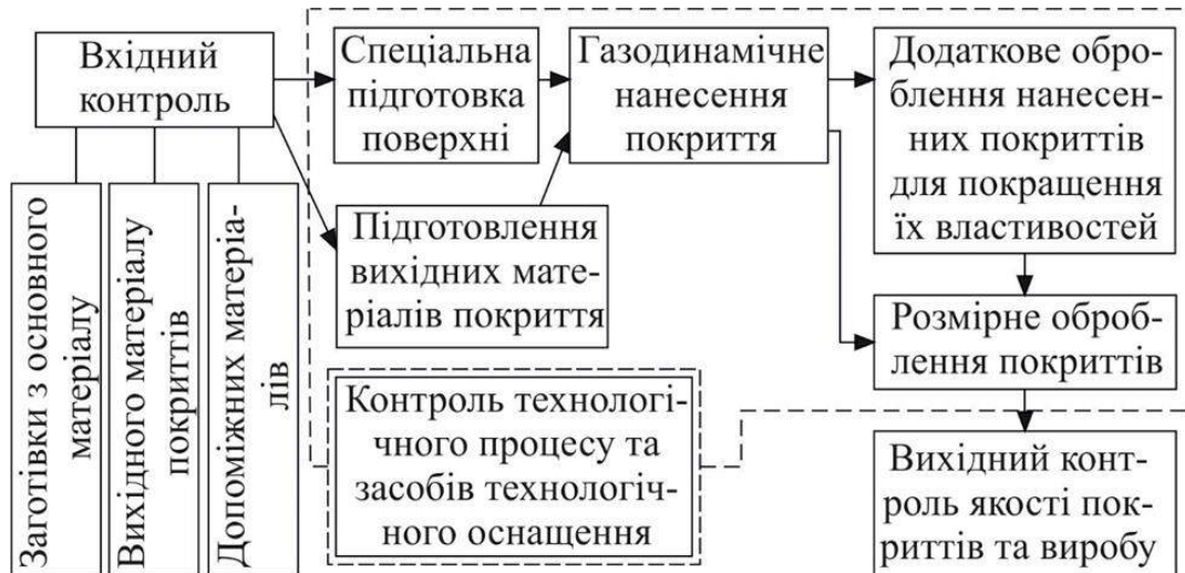
Рисунок 5.1 – Технологічна схема отримання газодинамічних покриттів.
