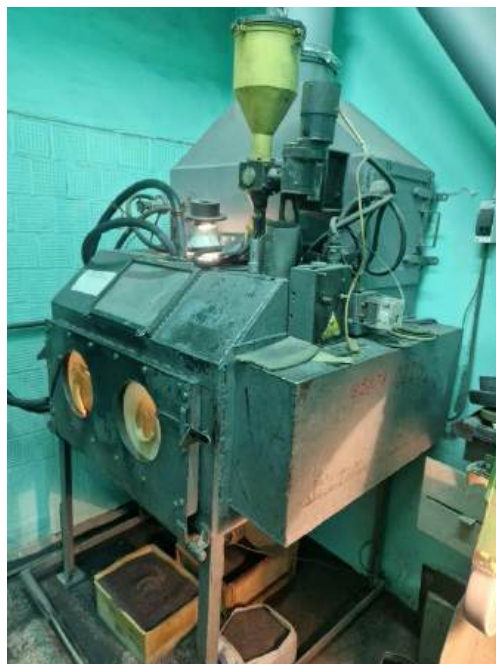
Рисунок 5.3 – Камера для струминно-абразивного оброблення.
