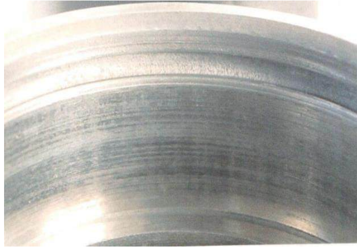
Рисунок 5.7 – Зовнішній вигляд відновленої поверхні корпусу сателіту після випробувань.
