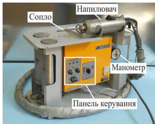
Рисунок 2.1 – Зовнішній вигляд установки ХГН НТ ДИМЕТ-405.
