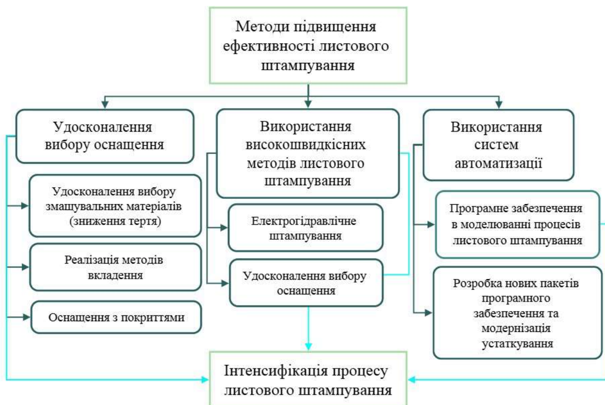
Рисунк 1.17 – Методи підвищення ефективності листового штампування
