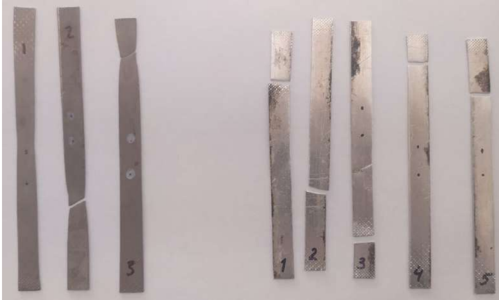
Рисунок 4.3 – Зразки для випробування на розтягування
