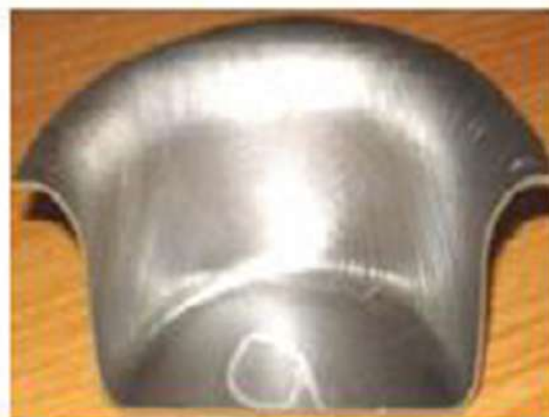
Рисунок 1.11 – Вимірювання товщини витянутого стакану: а – позиції вимірювання після розрізання витянутого стакану: б – розрізаний стакан [49]
