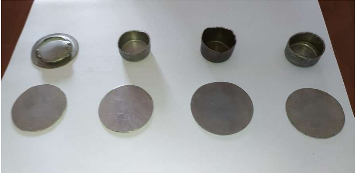
Рисунок 4.12 – Деталі після розривного навантаження (зусилля)
