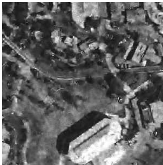
Рисунок 2.16 – Зображення FR01: на виході фільтра Фроста 13x13 (а); на виході фільтра ДКП з фіксованим \beta=4,8 , 8x8 (б); на виході фільтра НМ 2 (в)
