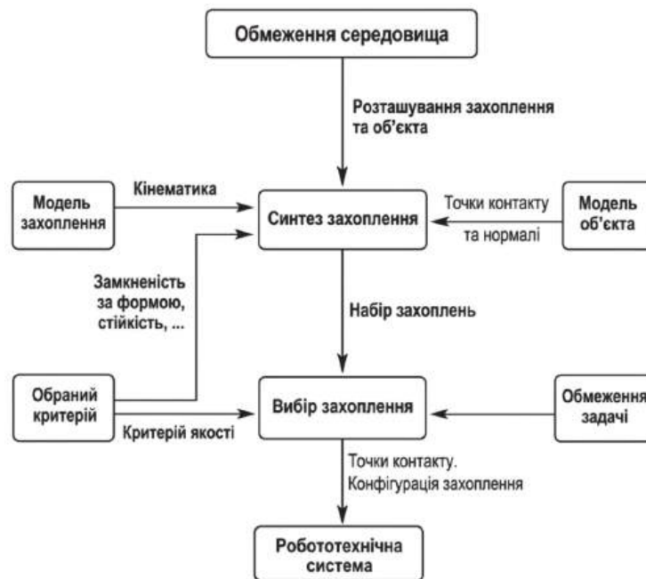
Рис. 1 – Схема планування захоплення об'єкта з використанням аналітичного підходу
