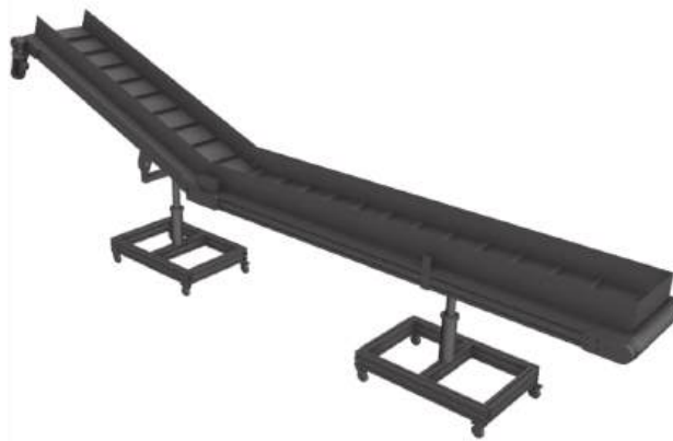
Рис. 1 – 3D CAD-модель транспортуючої машини
