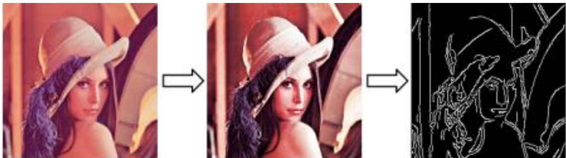
Рисунок 1.8 – Приклад роботи контурного детектора Кенні
