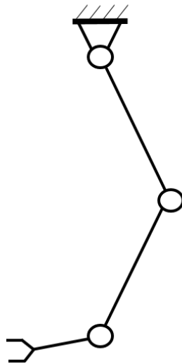
Рисунок 3.67 – Кінематична схема триланкового маніпулятора
