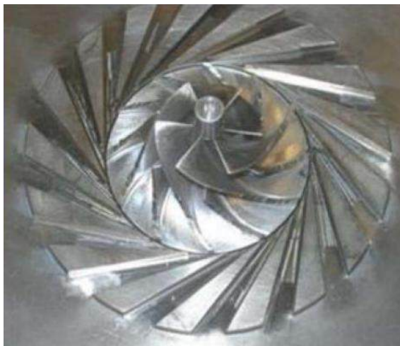
Рис. 3.3. Експериментальний зразок та компресор, спроектований у AxSTREAM™
