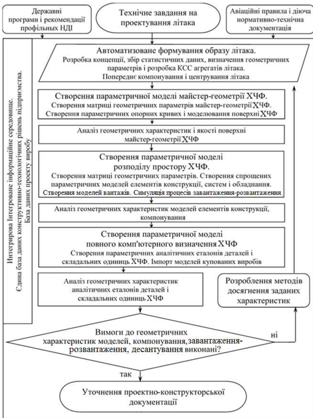
Рисунок 2.30 – Схема методу параметричного моделювання ХЧФ
