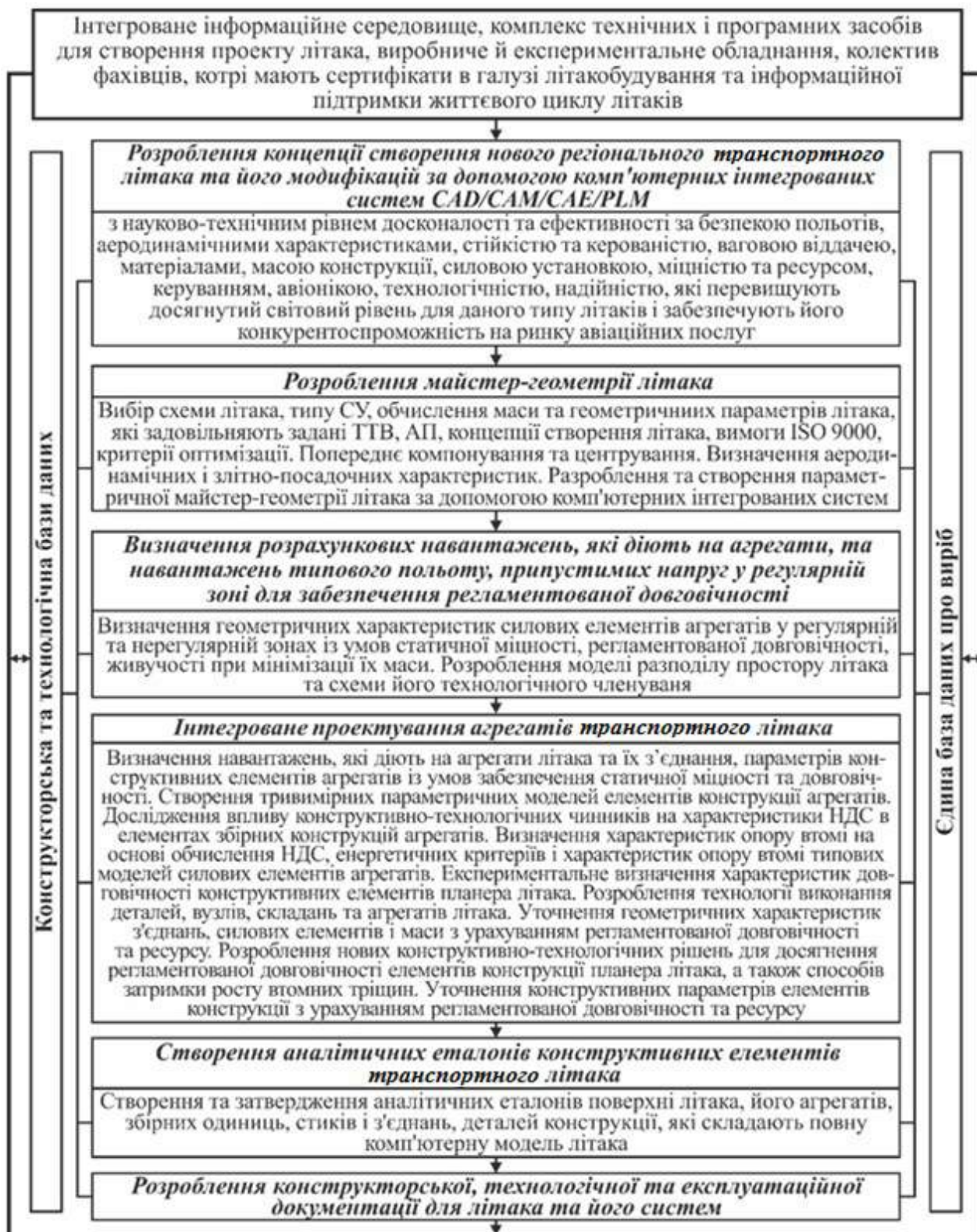
Рисунок 1.1 – Блок-схема загального методу інтегрованого проєктування літака транспортної категорії
