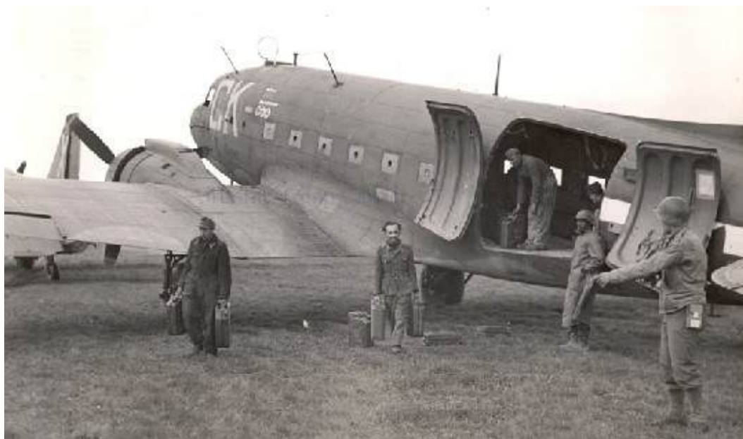
Рисунок 1.16 – Зовнішній вигляд двостулкового бокового вантажного люка літака C-47
