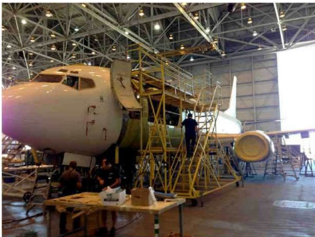
Рисунок 1.9 – Зовнішній вигляд процесу переобладнання пасажирського Boeing 737-400 в вантажний Boeing 737F
