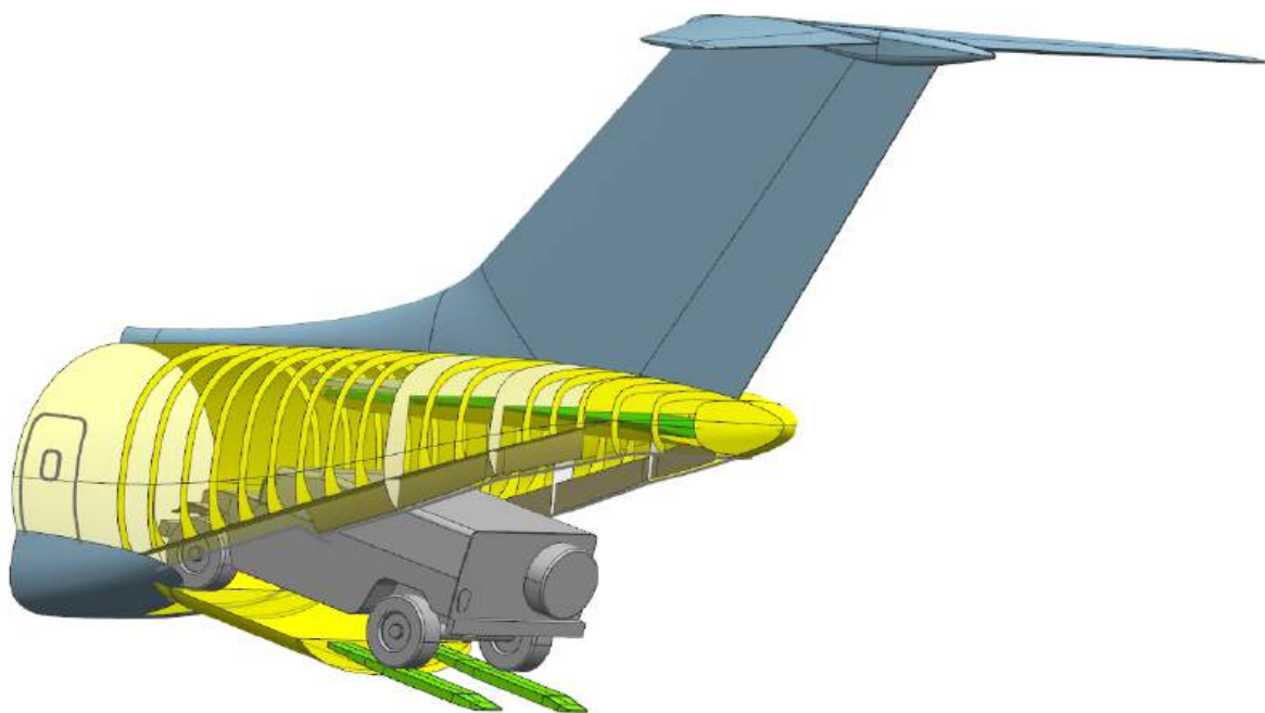
Рисунок 1.38 – Загальний вигляд симуляції завантаження самохідної техніки в вантажну кабінку літака за допомогою використання CAD системи Siemens NX
