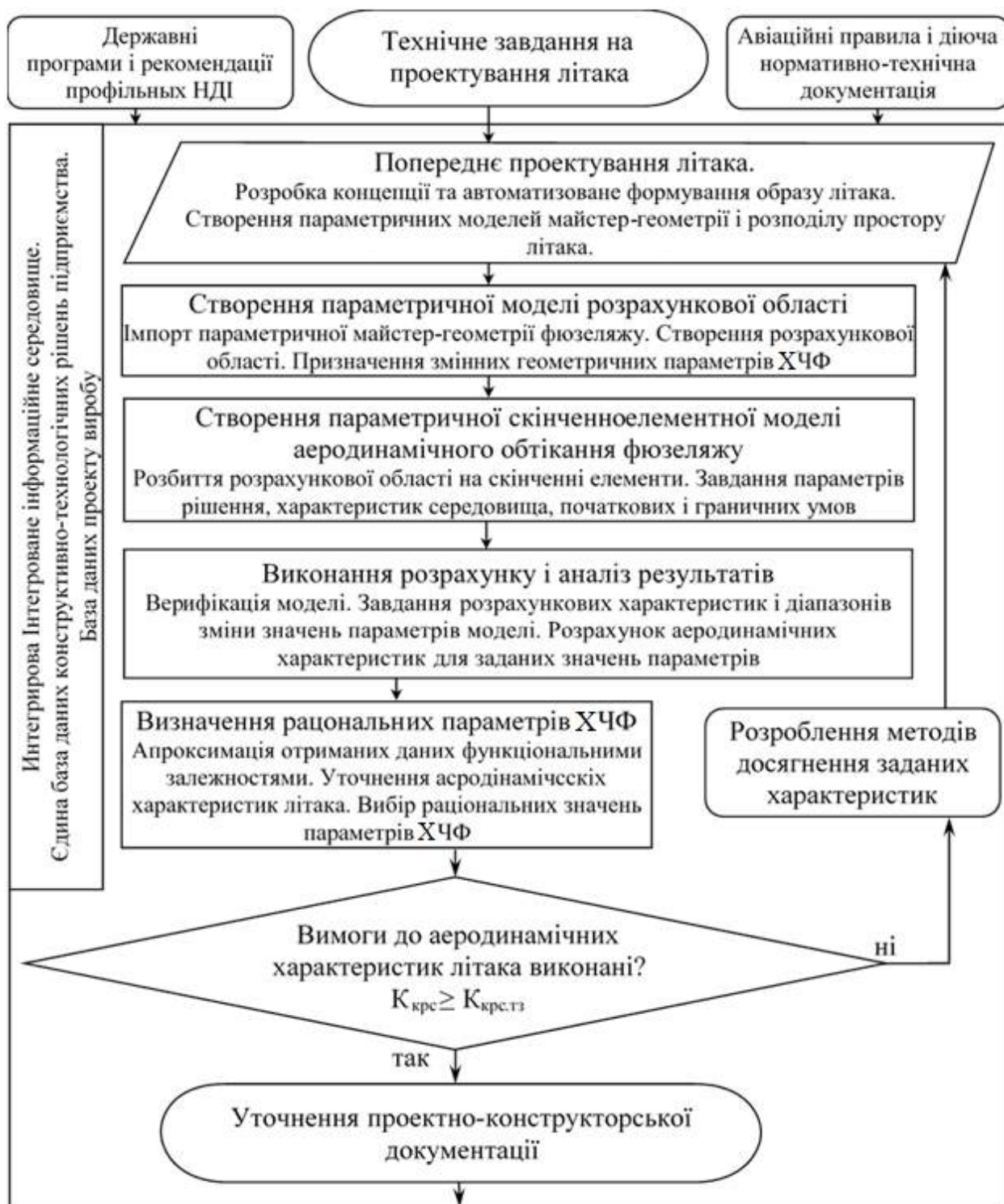
Рисунок 2.37 – Блок-схема методу моделювання аеродинамічного обтікання фюзеляжу з урахуванням геометричних особливостей хвостової частини фюзеляжу
