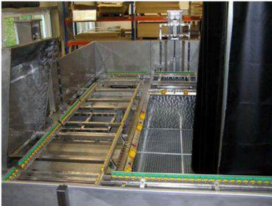
Рис. 6.5. Механізована лінія з транспортною системою рольгангів і механізмів підняття/опускання виробу у ванну з реактивами
