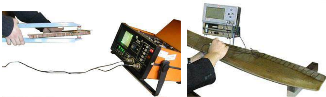
Рис. 7.9. Контроль металевих і неметалевих клеєних стільникових конструкцій
