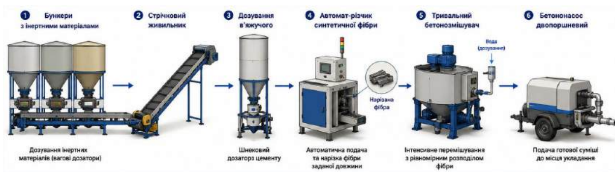
Рис. 1. Автоматизована лінія виробництва будівельної суміші з синтетичною фіброю
