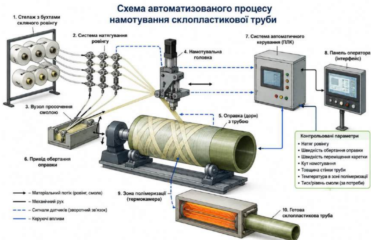
Рис.1. Схема автоматизованого процесу намотування склопластикової труби
