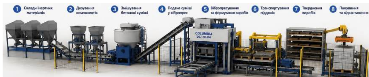
Рис. 2. Автоматизована лінія виробництва декоративних елементів мощення методом вібропресування
