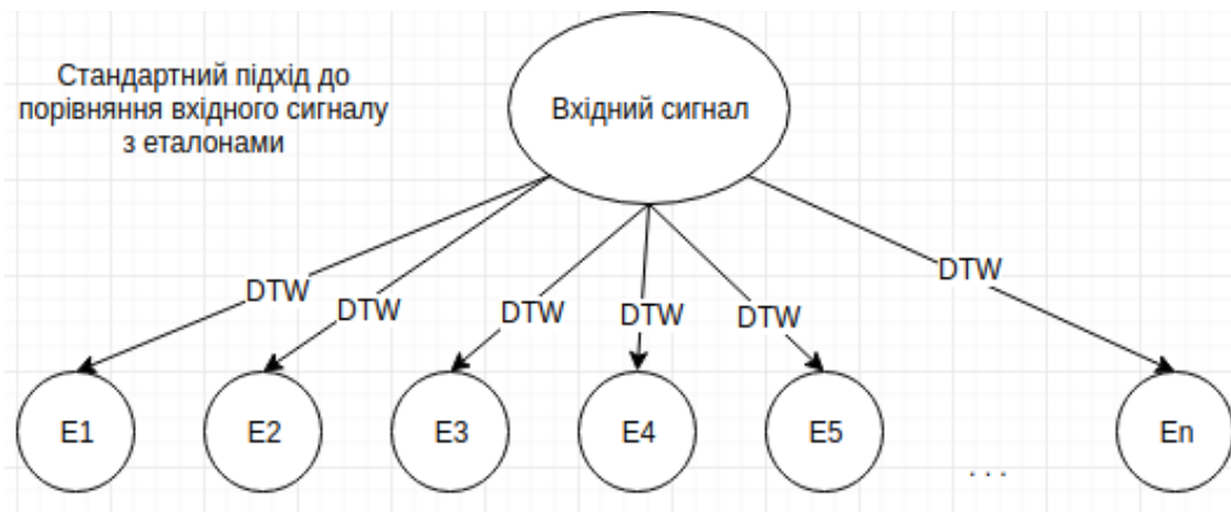
Рисунок 3.1 – Робота стандартного алгоритму динамічної трансформації часової шкали.
