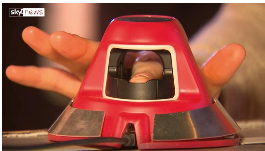
Рисунок 1.4– Пристрій для аналізу розташування вен на пальці людини
