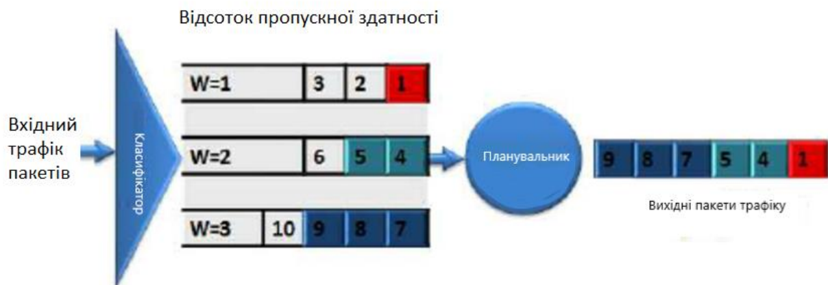
Рисунок 2.3 – Візуалізація роботи алгоритму WRR
