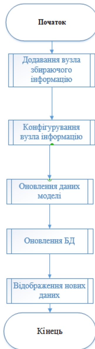
Рисунок 2.16 – Блок-схема алгоритму збирання даних
