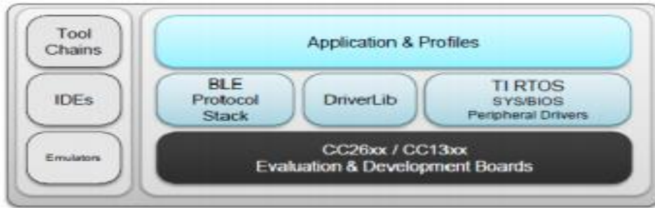
Рисунок 2.25 – Склад системи розробки під CC2650
