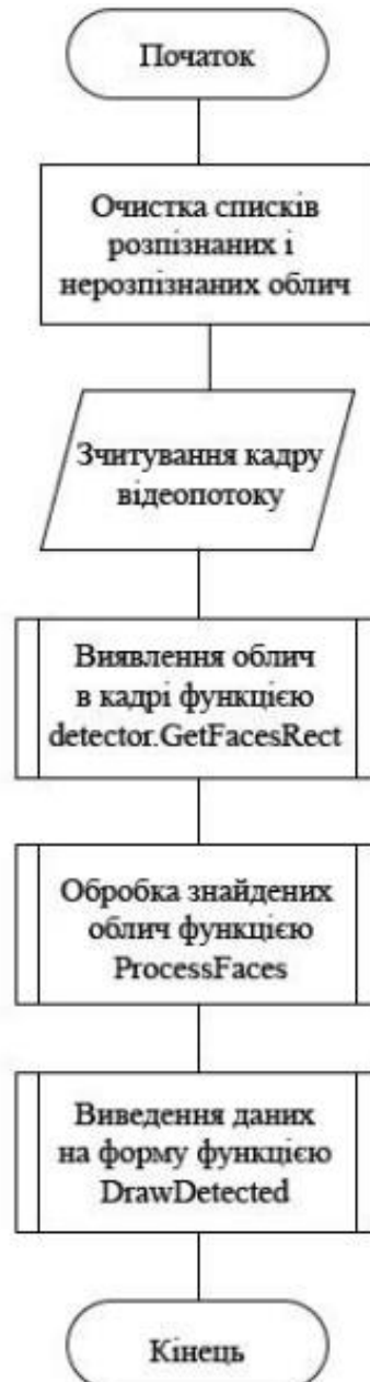
Рисунок 3.6 – Блок-схема методу обробки кадрів відеопотоку
