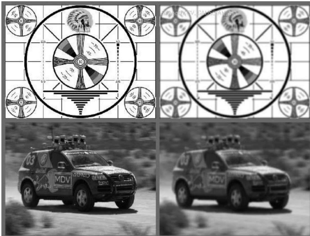
Рисунок 2.3 - Розмиття по Гаусу на одновірному масиві
