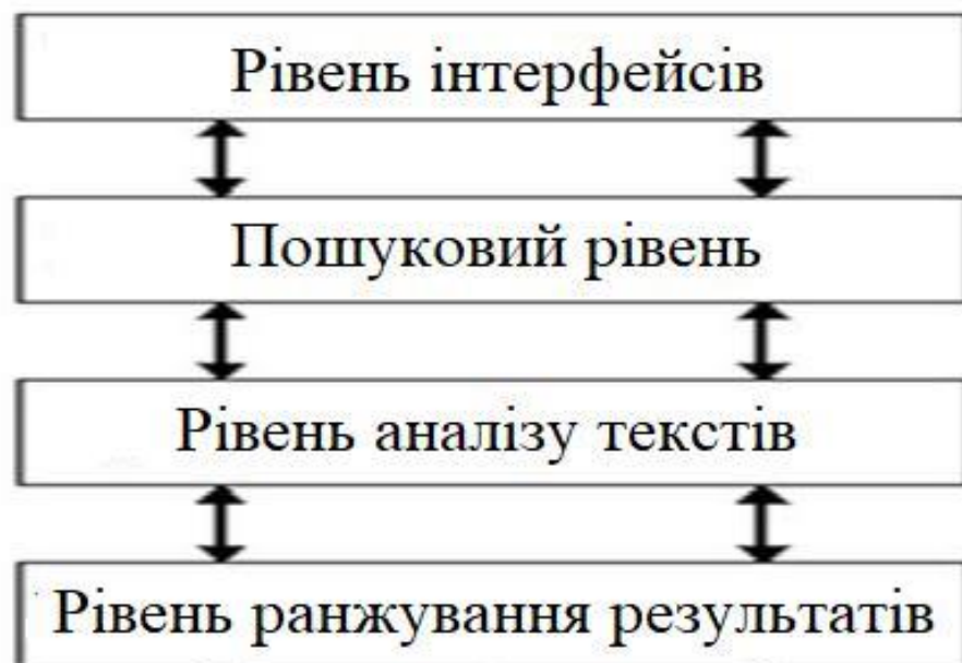
Рисунок 3.2 – Функціональна схема МАС для одномовного пошуку
