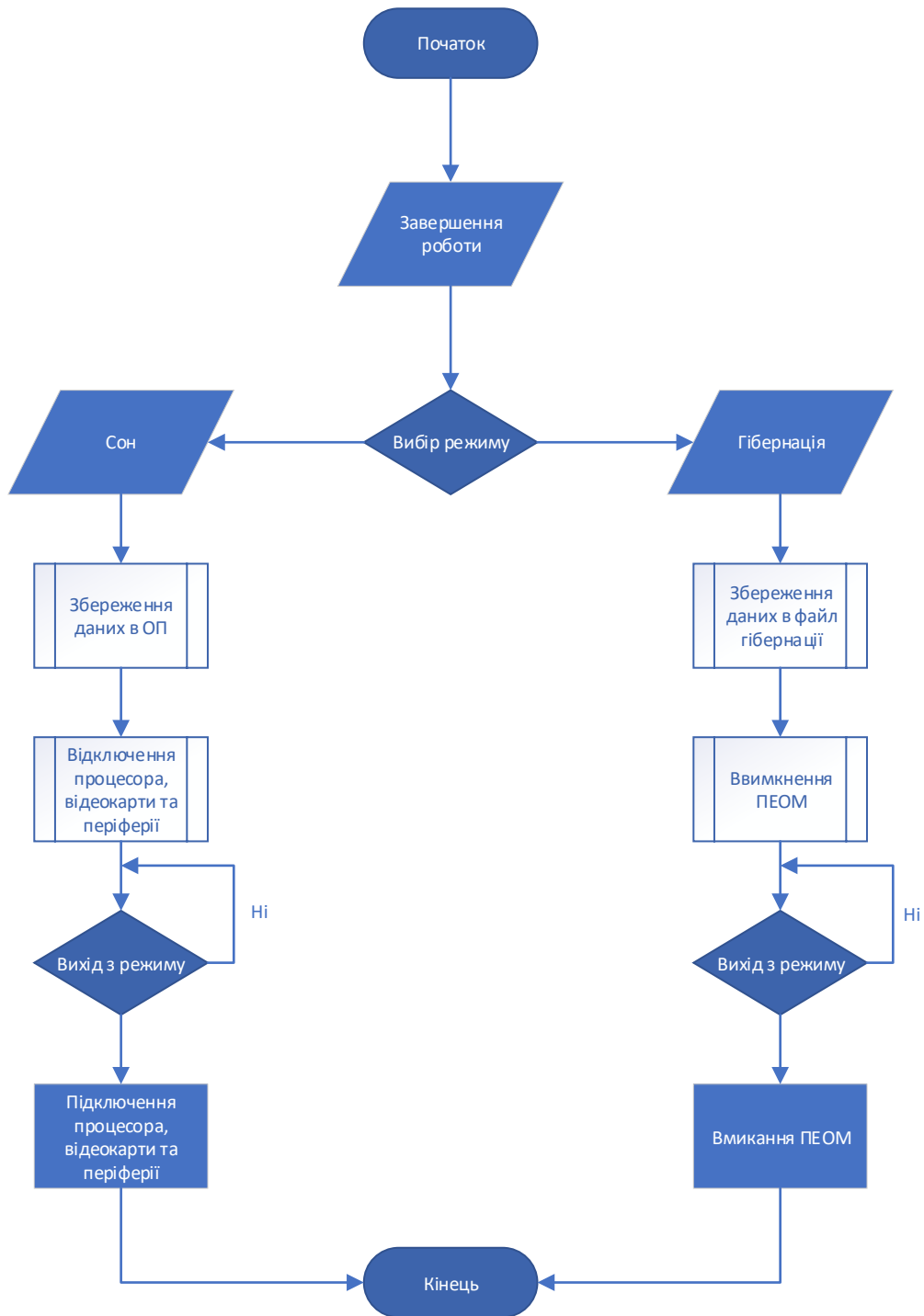
Рисунок 2.3 - Блок-схема роботи режимів енергозбереження
