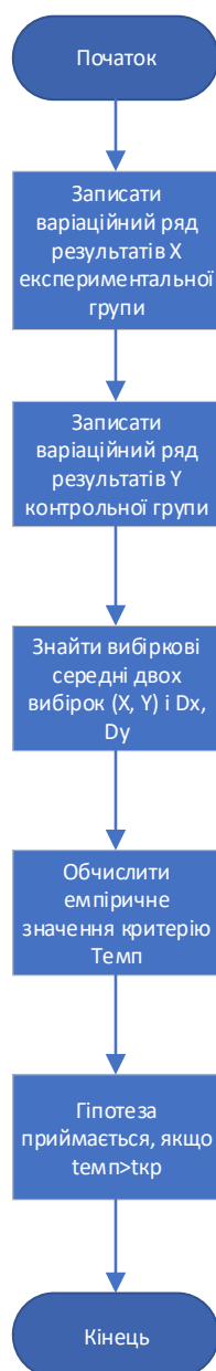
Рисунок 2.6 - Блок-схема алгоритму визначення t-критерію Стьюдента
