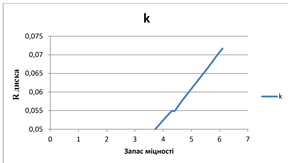
Рисунок 2.28 - Зміна запасу міцності по радіусу диска
