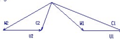
Рисунок 1.15 – Плани швидкостей в перерізі r = 0,8691
