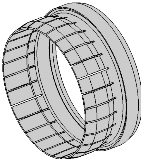
Рис 4.12 – Цанга пружно-демпферної опори
