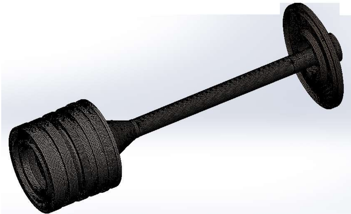
Рисунок 4.9 – Сітка спрощеної масово-жорсткісної моделі ротора
