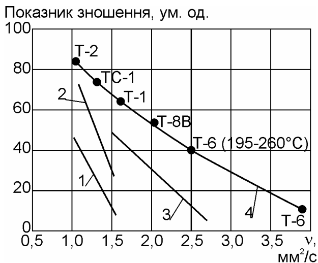
Рис. 2.8. Вплив в'язкості палив на їх протизношувальні властивості: 1 — РТ; 2 — ТС-1; 3 — Т-6; 4 — палива, очищені від поверхнево-активних речовин
