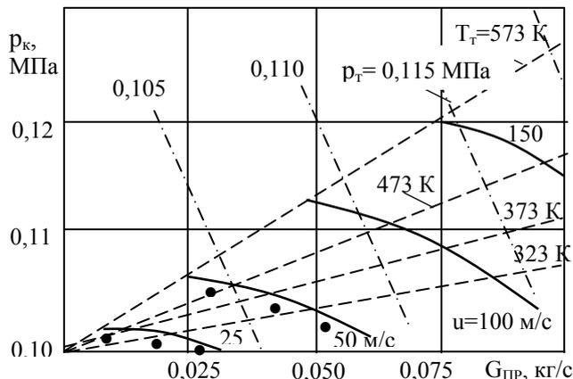
Рис. 3. Характеристика турбокомпрессора с общим рабочим колесом:
