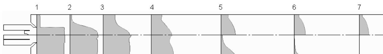
Рис. 12. Эпюры концентрации O_2 в сечениях 1 – 7: вверху – при наличии лопаточного завихрителя; внизу – при отсутствии лопаточного завихрителя
