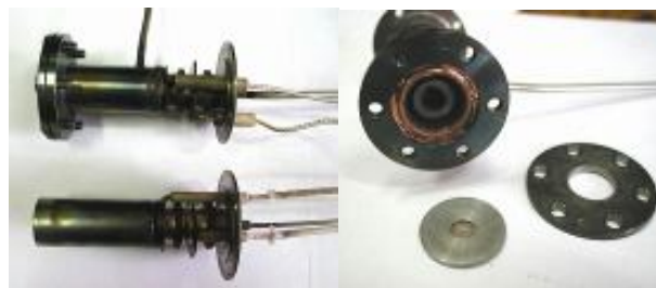
Рис. 1 Лабораторная модель катода с блоком сменных диафрагм
