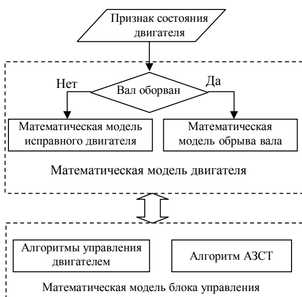
Рис. 5. Функциональная схема программного комплекса для тестирования алгоритма АЗСТ
