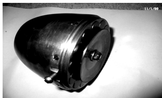
Рис. 1. Узел автоматического клапана ПуВРД
