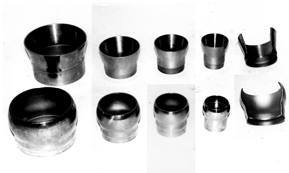
Рис. 2. Готовые изделия – усиленные сферические и конусные наконечники для труб диаметрами 32, 42, 50 и 80 мм
