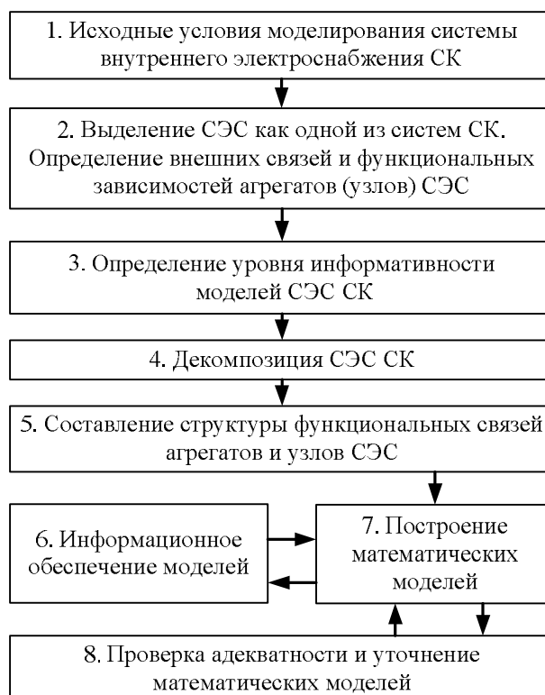
Рис. 1. Блок-схема концепции построения математических моделей систем электроснабжения стартовых комплексов
