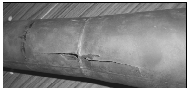
Рис. 11. Разрушение камеры сгорания в результате суммарной наработки 60 минут в условиях горячих стендовых испытаний
